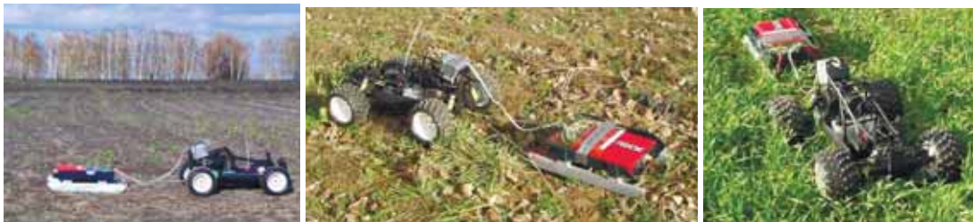
Рис. 6. - Вимірювання ЕП властивостей ґрунту на різних агрофонах: оранка та поверхневий обробіток ґрунту, після чизелювання та по сходах трав відповідно.
