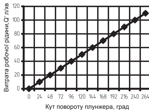
Рис. 2. Тарувальна характеристика витратоміра постійного перепаду тиску.
