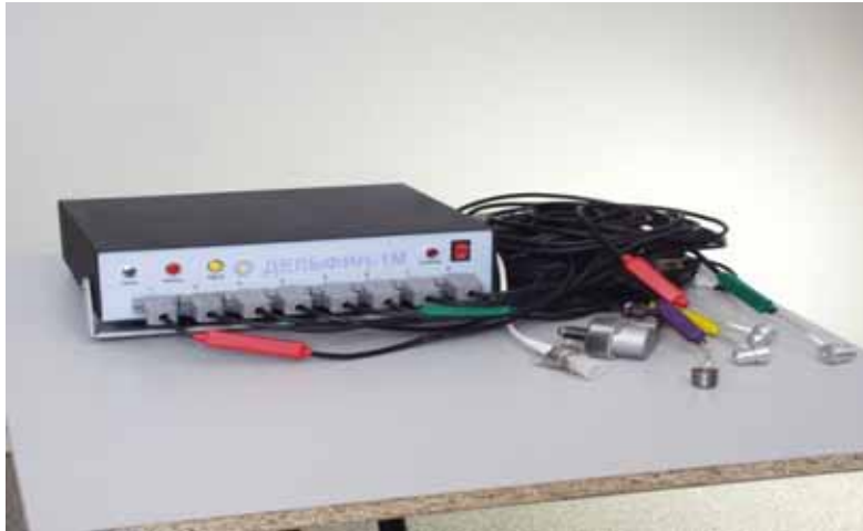
Рисунок 1 – Стенд віброакустичної діагностики «Дельфін –1 М»
