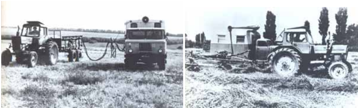
Рис. 1 - Тензометрування с.-г. машин в 1982 році вироблені в УкрМІС
