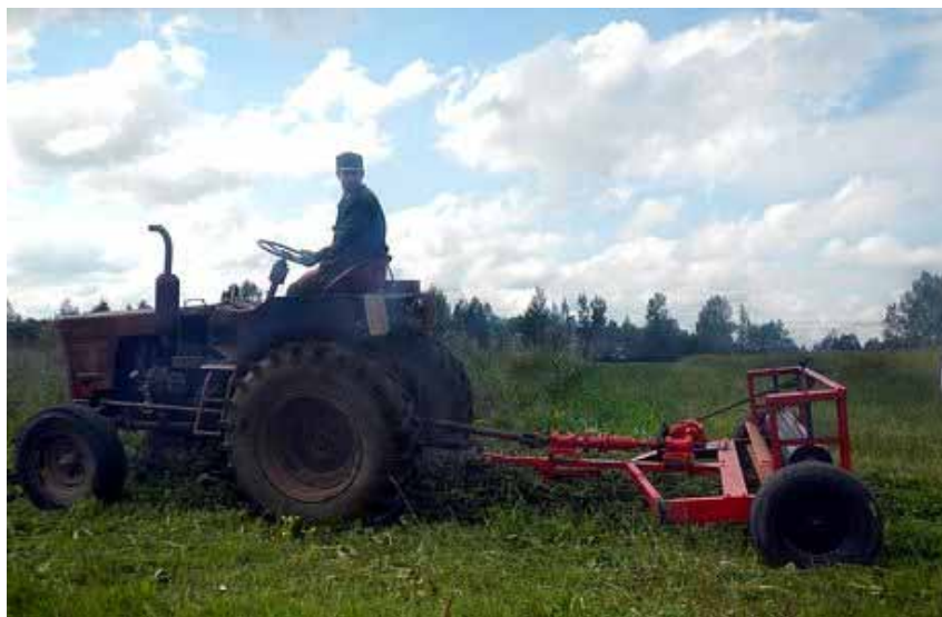
Рис. 5. Машина для плющения стеблей скошенных трав (разработка Великолукской ГСХА)
