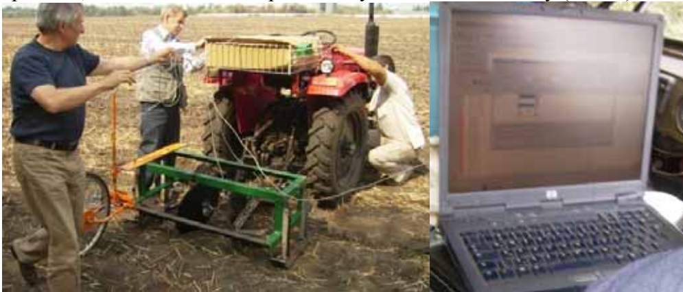
Рис. 3 - Проведення польового експерименту: а) вимірювальний комплекс; б) реєстрація інформації на ноутбуці.
