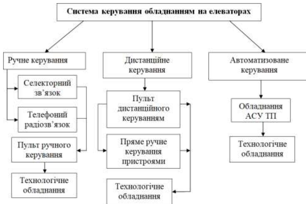
Рис. 1. Схема забезпечення керування обладнанням на елеваторах
