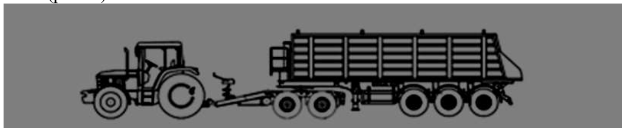
Рис. 1 Схема тракторного автопоїзда з ПСП-20
