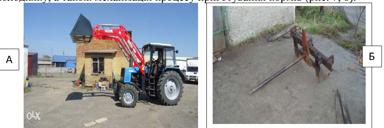
Рис. 7. Завантаження зерна у вантажний автомобіль за допомогою навісного обладнання до трактора з ківшом (А), а рулонів соломи – спец. штирем (Б)
