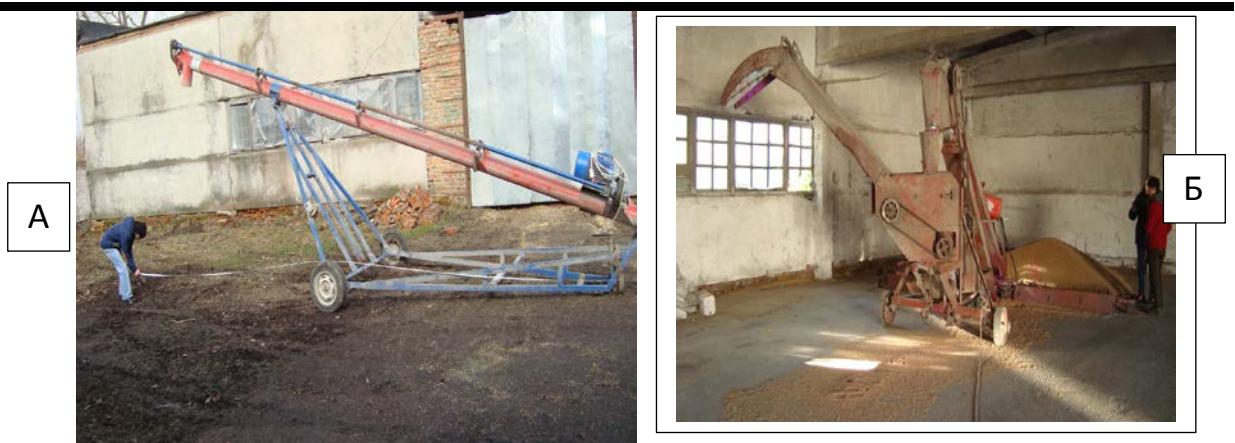
Рис. 5. Завантаження зерна у вантажний автомобіль гвинтовим перевантажувачем (А) за допомогою зерномета (Б)
