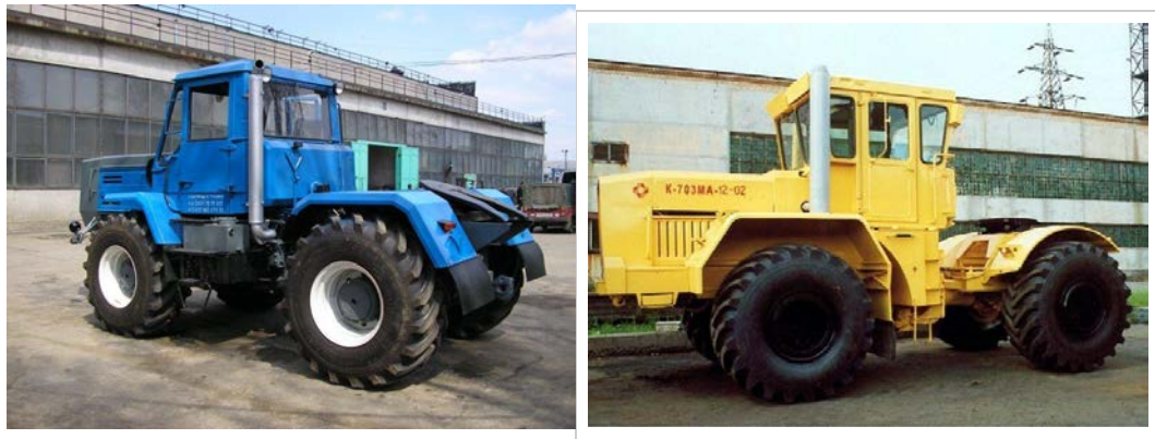
Рис. 22. Трактори з сідельним зчіпним пристроєм: ХТА-200-5 та К-703 МА-12-02
