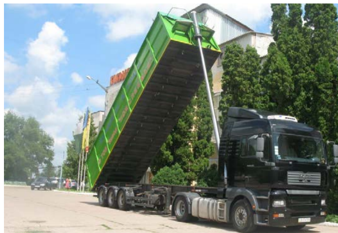
Рис. 23 Автомобільний напівпричіп-самоскид НПС 2150 (Україна) з автотягачем
