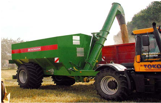
Рис. 20 Вивантаження зерна на краю поля в кузов великовантажного АТЗ
