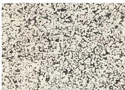
Рис. 2. Мікроструктура сплаву сплаву КХНФ-15, х 400
